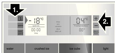
La temperatura del compartimento de congelación se puede ajustar de -14 °C hasta -24 °C.
